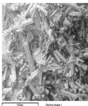
Figura 86. Aspectul suprafeței granulei de [\text{Zn}(\text{TEO})_2](\text{CH}_3\text{COO})_2
