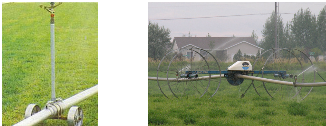
Figura 4.8 Instalații de aspersiune cu deplasare mecanizată pe roți [93, 116]
