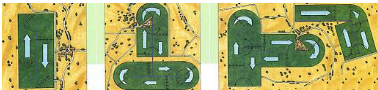
Figura 4.68 Scheme de udare și mutare folosind instalațiile cu deplasare liniară și circulară [83]
