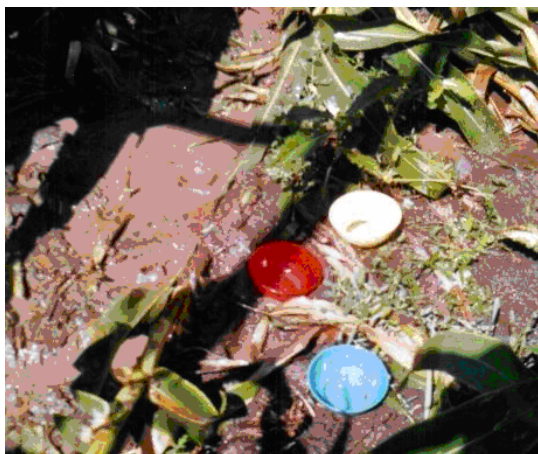
Figura 5.51 Vasele pluviometrice folosite pentru colectarea apei aspersate (foto Cîmpan G.)
