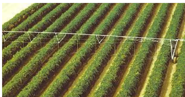
Figura 4.24 Instalație de udare cu deplasare liniară [93]
