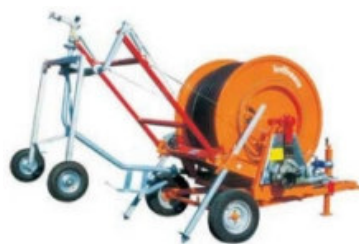
Figura 4.10 Instalația cu tambur și furtun propriu-zisă [94]
