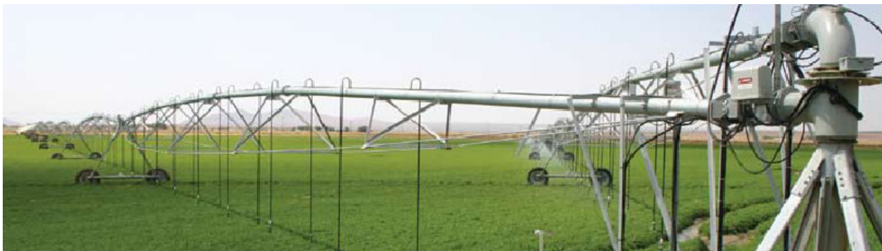
Figura 4.22 Instalația de aspersiune cu două aripi pivotante [115]
