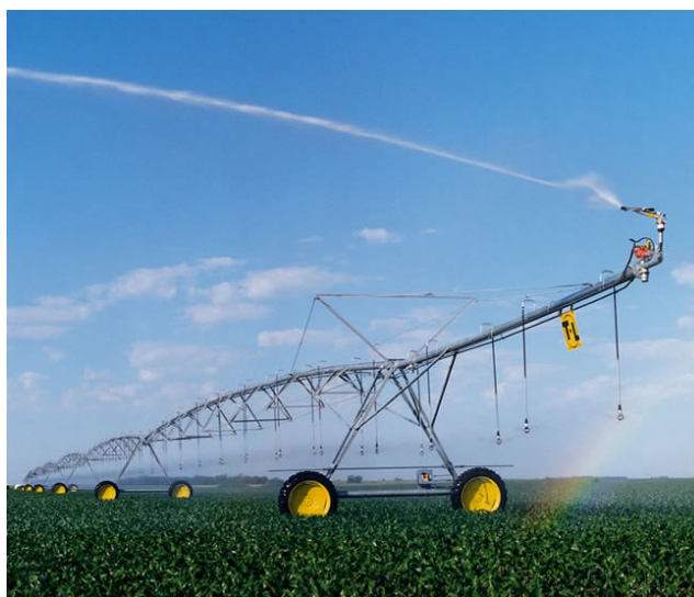
Figura 4.18 Instalație de aspersiune cu pivot central prevăzută cu braț suplimentar [110]
