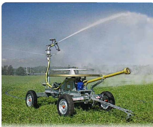
Figura 4.12 Instalație de udare cu cablu [84]
