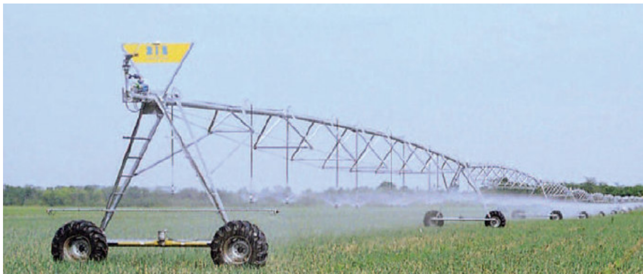
Figura 4.16 Instalația de aspersiune cu pivot central în funcțiune [117]
