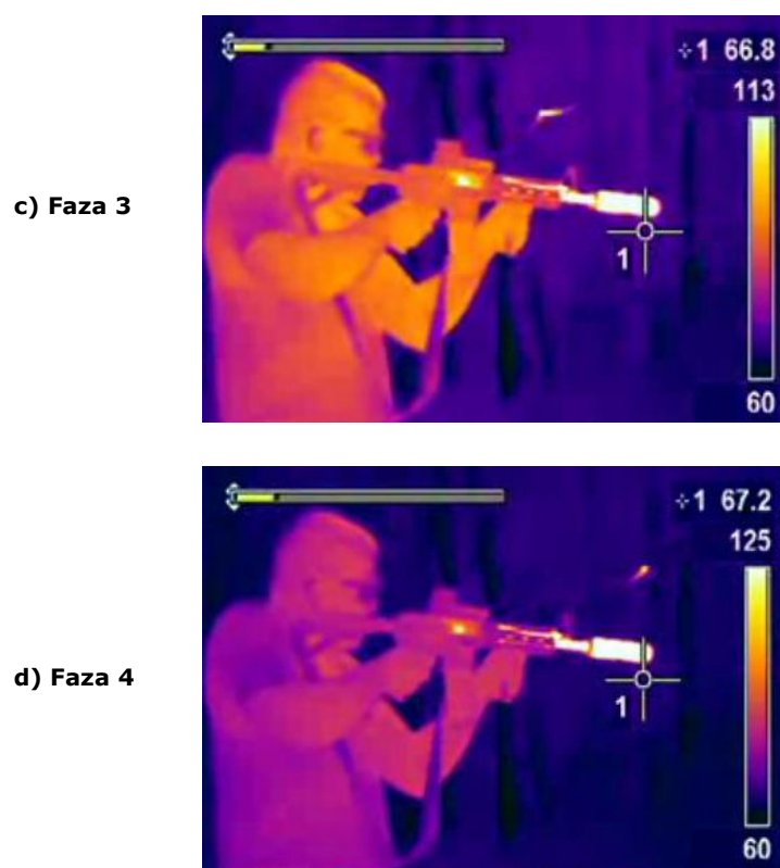
Fig. 2.26. Fazele încălzirii pistolului mitrarielă „Colt Commando”
