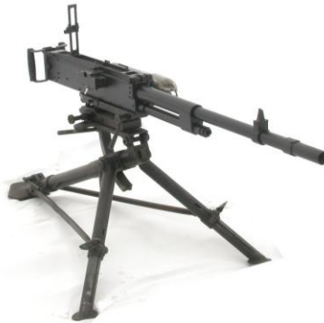
Fig. 2.7. Model de mitralieră de mare viteză „Breda M37” (> 900 focuri/min) – [81]
