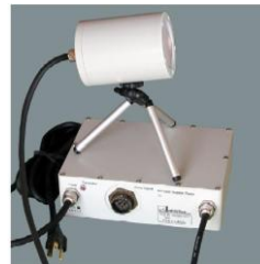
b) Radar de mare viteză „Dopler” pentru măsurarea vitezei proiectilelor
