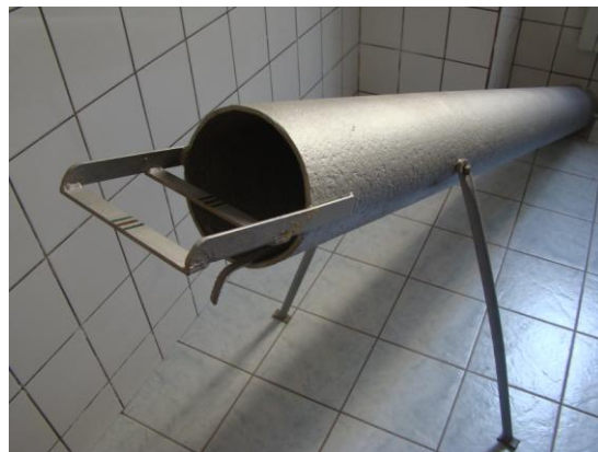
Fig. 4.22. Sistemul de ghidare al recuperatorului pentru proiectile trase cu arme de foc
