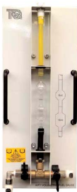
Fig. 3.28 Indicatorul de combustibil volumetric AVF 1
