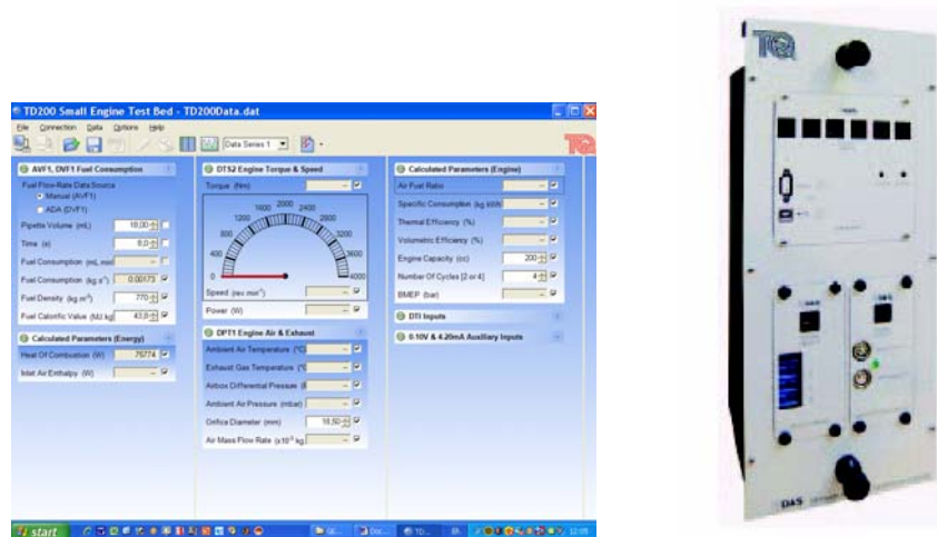
Fig. 3.30 Sistemul de achiziții de date multilateral - VDAS
