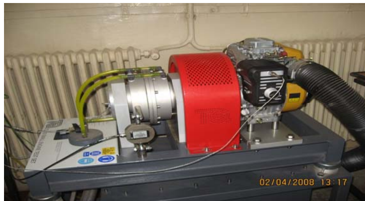
Fig. 3.25 Bancul de încercare cu frână hidraulică
