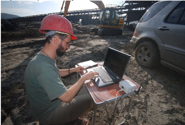
Fig 3.17 Citirea datelor folosind un laptop si receptor wireless
