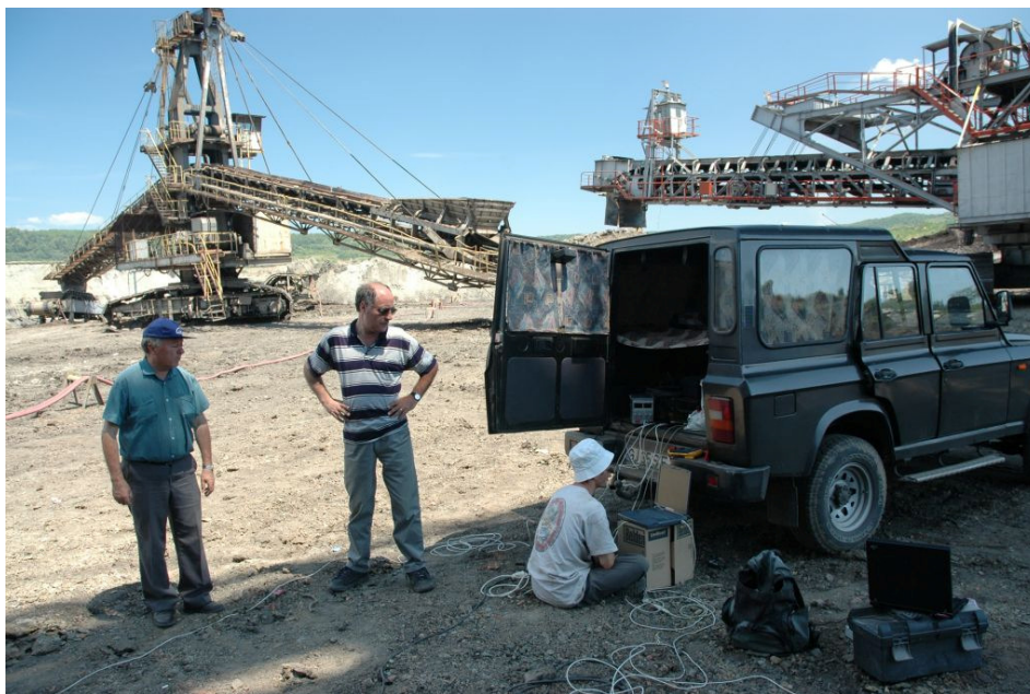
Fig. 1.2 Măsuratori tensometrice multicanal cu fir, partea de achiziție . Fiecărui canal îi erau atribuite un fir precum și un set de interfețe.
