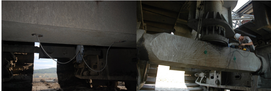
Fig. 3.6 Amplasarea timbrelor tensometrice pe bughiul șenilelor
