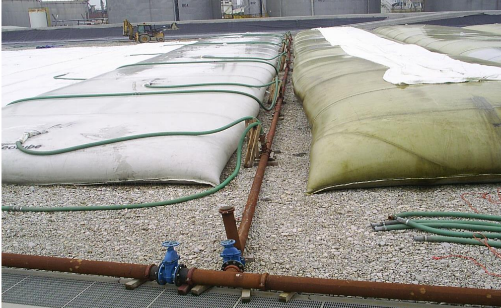
Fig. 6.13 – Depozitarea în sistem geotube Tencate
