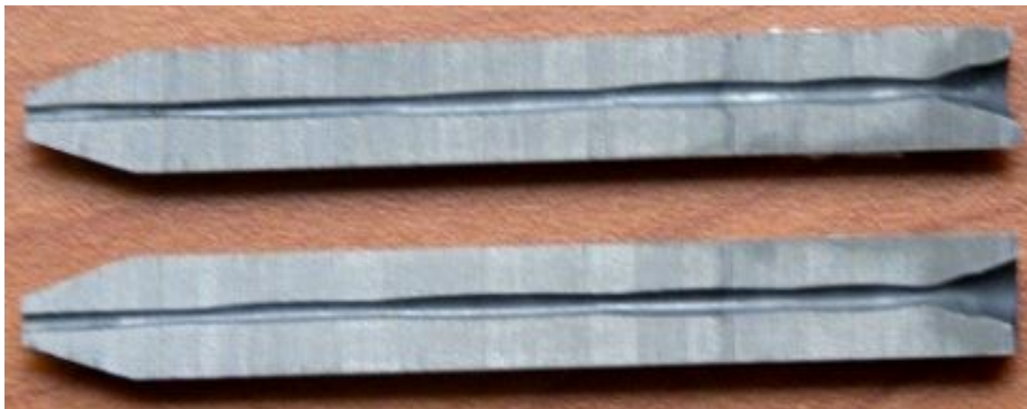
Figura 5.3.6 Tubul de focalizare utilizat 159 de ore, modificat, secționat longitudinal.
