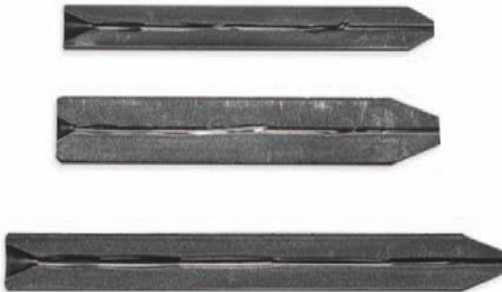
Figura 5.2.2 Uzura suprafeței interioare a tubului de focalizare [73]
