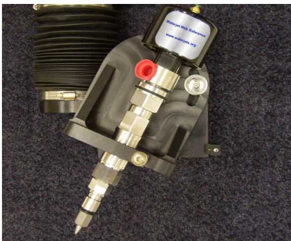
Figura 3.16. Capul de prelucrare automatizat (3D) [ 8 ]
