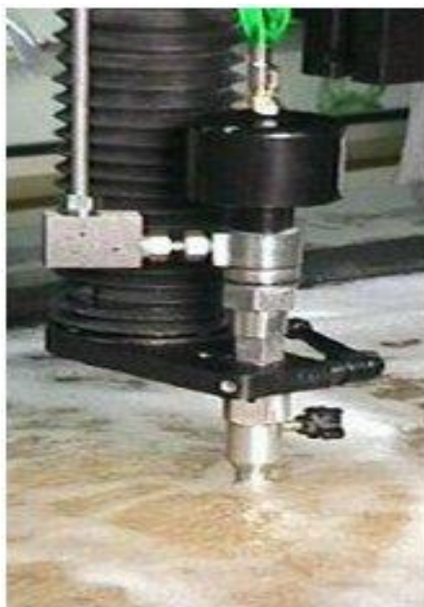
Figura 1.5.5. Prelucrarea cu jet imersat [ 3 ].
