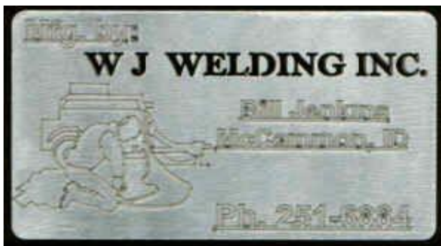
Figura 1.5.2. Gravarea materialelor cu jet de fluid [ 3 ]
