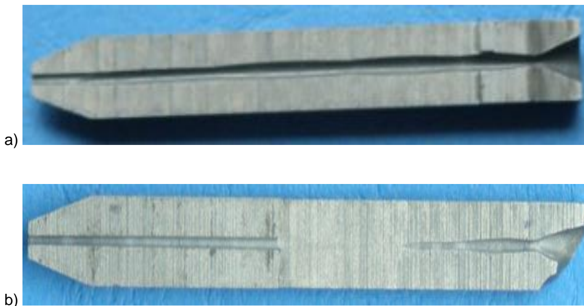
Figura 5.3.2 Uzura tubului de focalizare. a) neprelucrat înainte de utilizare, b) prelucrat înainte de utilizare
