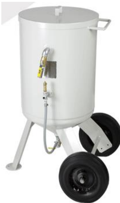
Figura 3.12. Sistem pentru stocare – alimentare cu abraziv [ 19 ].
