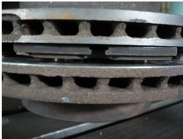
Fig. 5.32 Montajul cu 4 plăcuțe
