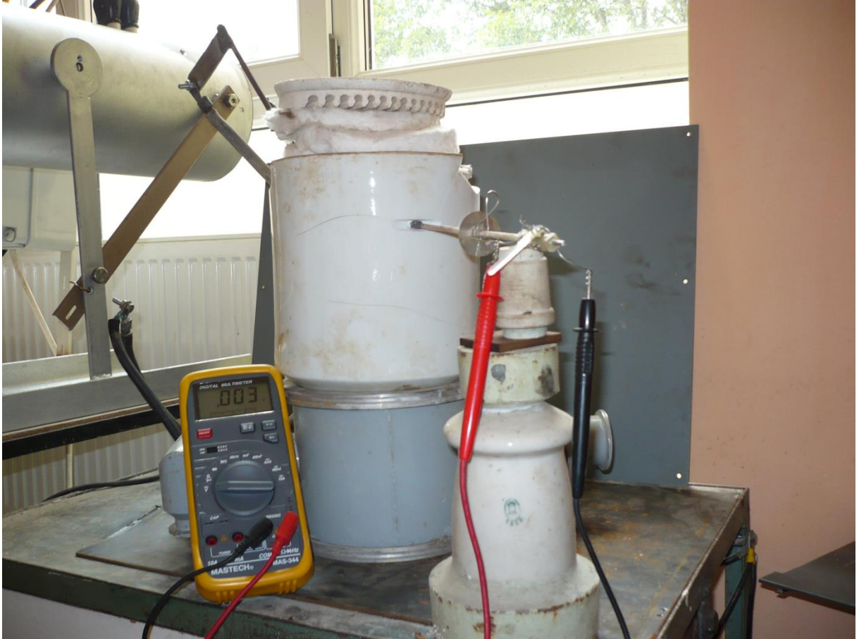
Fig. 5.8 Cuptor de topire a pulberii de bazalt
