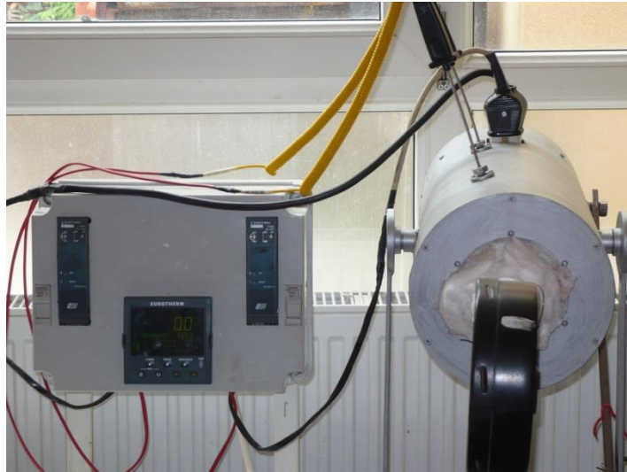
Fig. 5.14 Cuptor de uscare/calcinare
