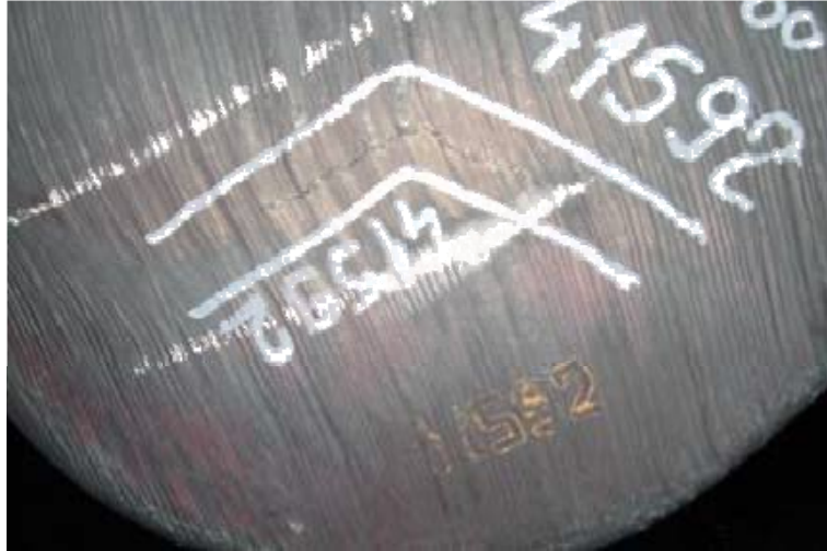
Figura 7.14. Fisuri interne la centru
