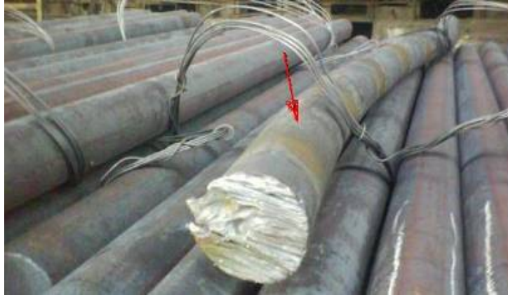
Figura 7.19. Bare prezentând defectul de curbura
