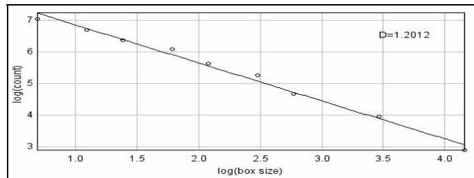
Fig.6.8. La dimension fractale du profil de rugosité de la surface de rupture par le programme Image J : \Delta=1,20
