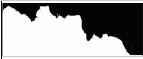
Fig.5.12. Contour du profil obtenu par la méthode de Section Verticale sur l'éprouvette en acier XC 65, après traitement thermique de trempé, (grossissement 400x)
