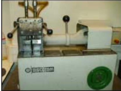
Fig. 5.10. Scie mécanique utilisée pour l'opération de coupe de l'échantillon en vue de l'application de la Méthode de Section Verticale
