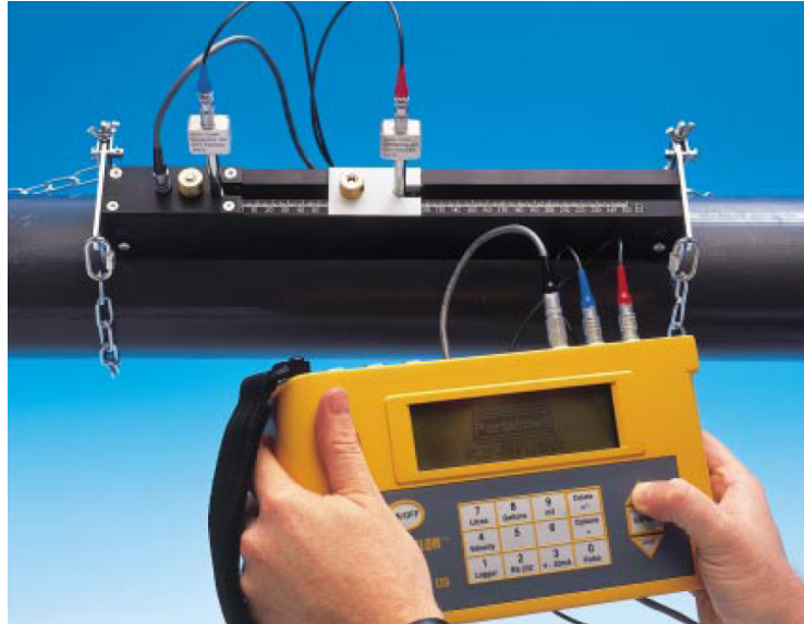
Fig. 3. 23. Ansamblul traductor debit - senzori ultrasunete
