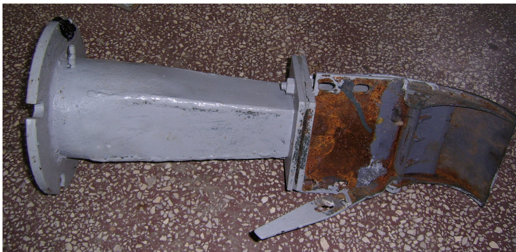
Fig. 3.17. Cofuzorul și ajutorul evolventic cu clapeta de reglarea a debitului
