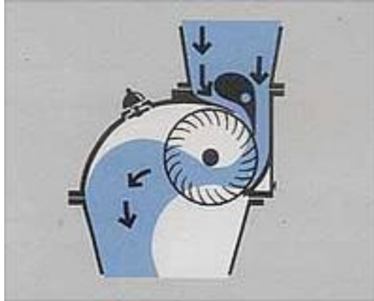
Fig. 1. 4. Variantă constructivă OSSBERGER cu intrare verticală
