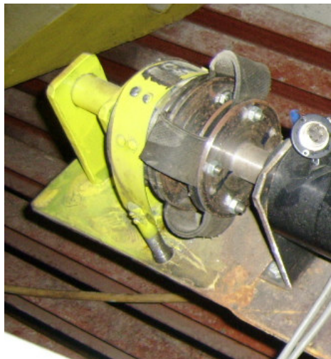
Fig. 4.1 Frâna mecanică cu bandă utilizată în vederea frânării turbinei cu dublu-flux
