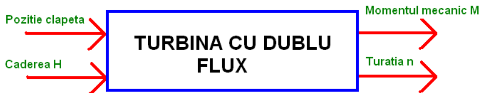
Fig. 4.10. Turbina cu dublu-flux privită ca un cvadripol informațional
