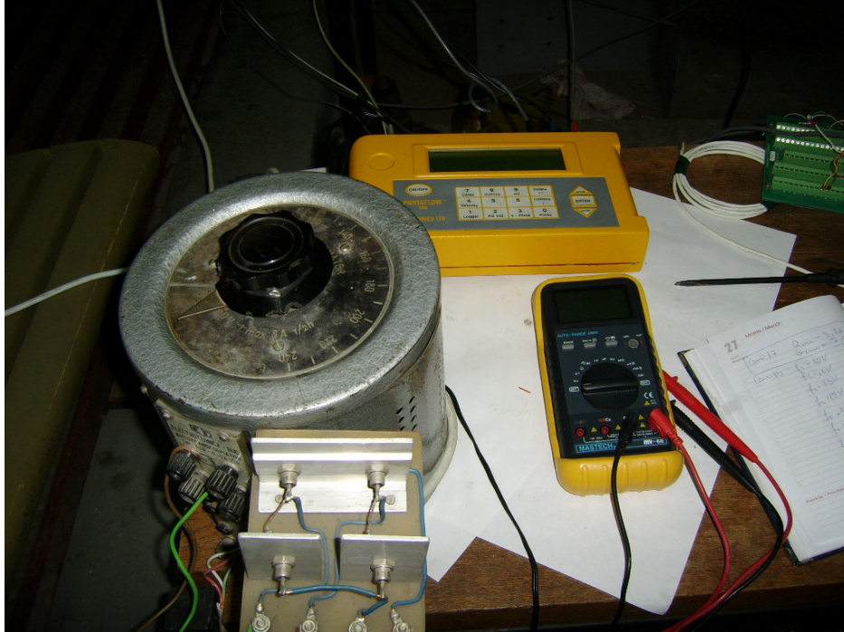
Fig. 4.11. Transformator cu tensiune reglabilă
