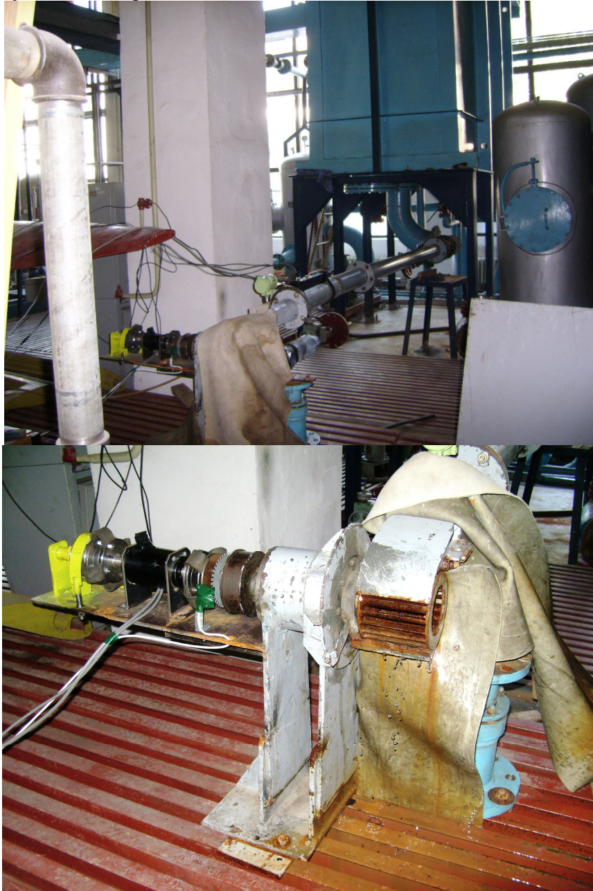
Fig.3.19. Stațiunea experimentală pentru testarea turbinei cu dublu flux
