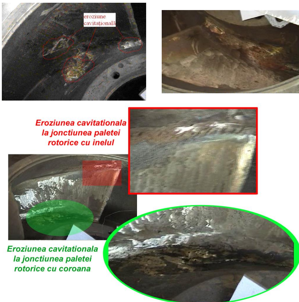
Figura 10.19. Marcarea zonelor erodate cavitațional pentru rotorul de pompă centrifugă MU 81, Anton et al., [14]
