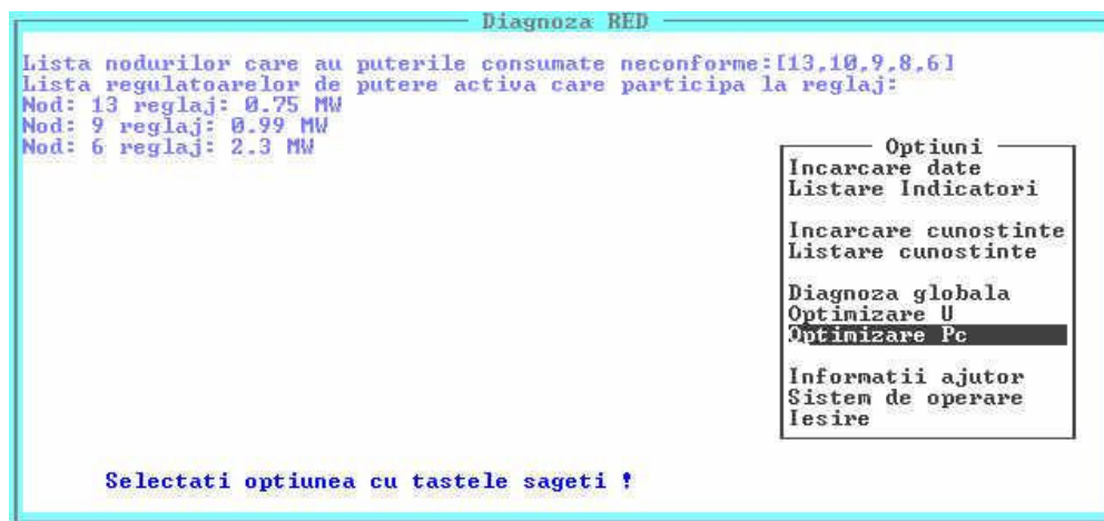
Fig. 6.11. Optimizarea puterilor active – DiagRED – modulul 2.
