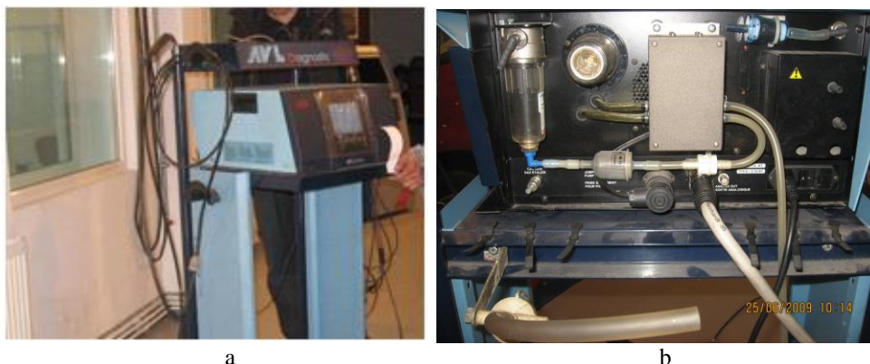
Fig 5.7. Analizor de gaze Dicom 4000 a-vedere analizor; b-vedere din spate
