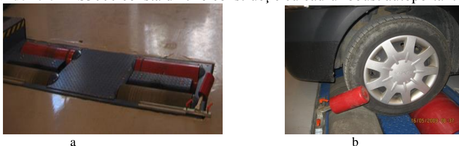
Fig. 5.5. Setul de role R100 cu care este echipat șasiul dinamometric LPS3000 a-stand cu role; b-poziționarea roții pe stand
