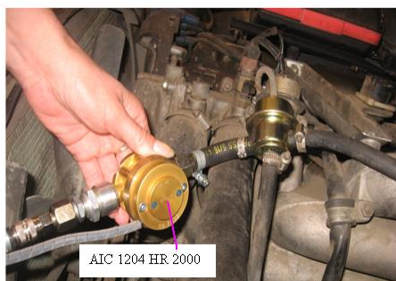
Fig.5.4. Dispozitiv pentru determinarea consumului de combustibil
