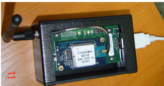
a. Stație de baza tip BU 2110
