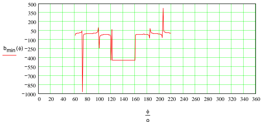
Fig. 5.33 Variația înălțimii minime b_{\min} [mm] a ghidajului funcție de unghiul de rotație al camei [°] urmare a analizei cinetostatice
