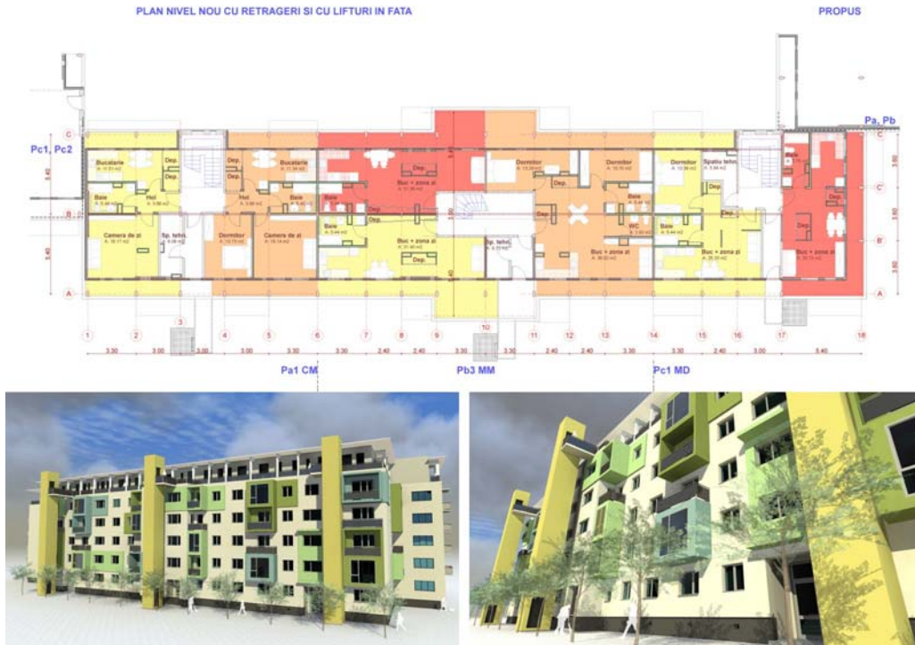
Fig.5.29. Plan nivel nou, cu retrageri și cu lift în față și imagini 3D
