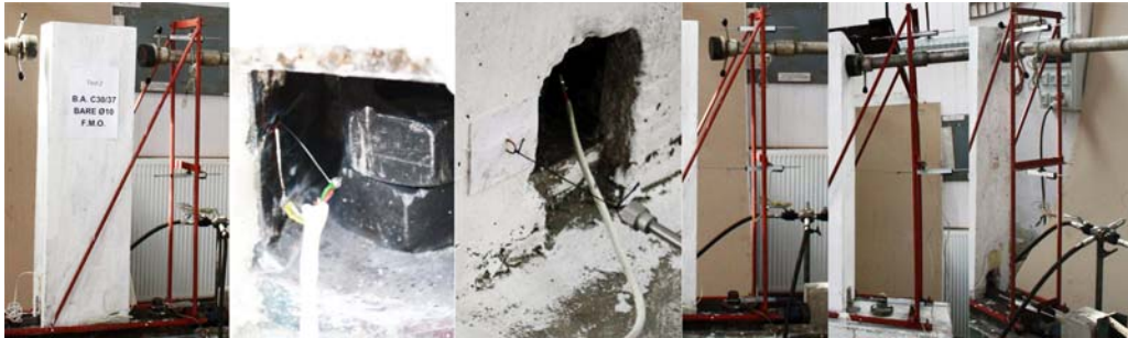
Fig.7.9. Elemente pentru măsurarea deformațiilor
