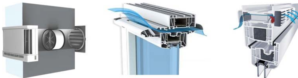
Fig.2.14. Grile de ventilare [www.aereco.com, www.gealan.de]
