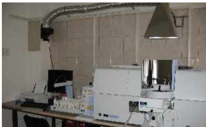
Figura 7.4: Spectrometru de absorbție atomică PERKIN – ELMER cu nebulizator și cuptor de grafit
