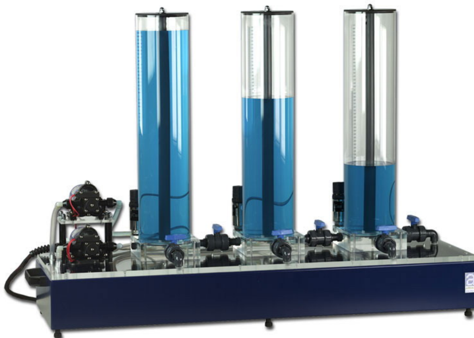
Figura 4.8 Sistemului cu trei rezervoare cilindrice (instalația de laborator DTS200 produsă de Amira GmbH Duisburg, Germany).
